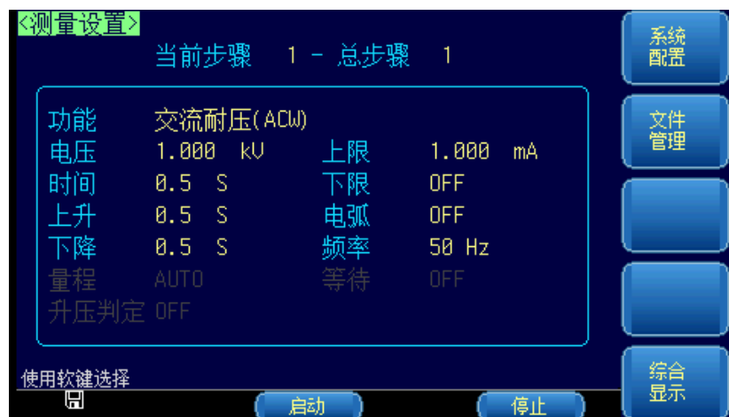
图 4-2 交流耐压测试参数设置页
