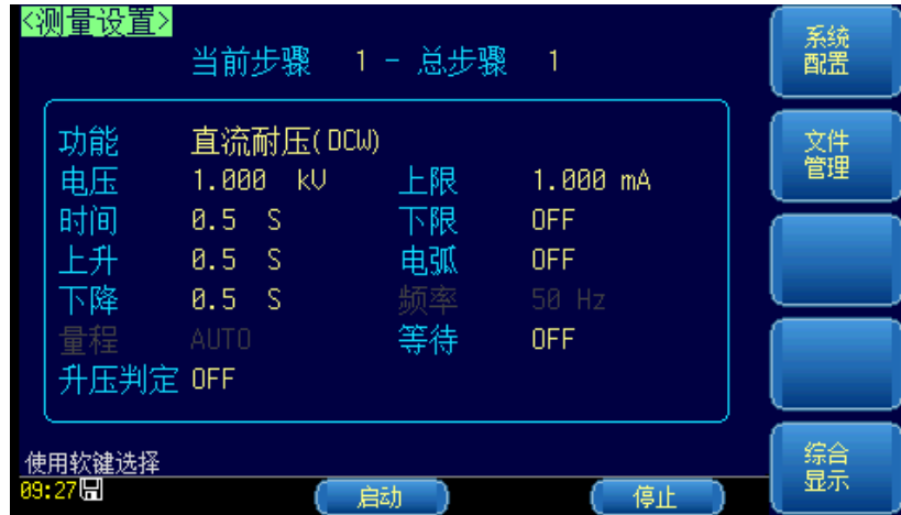
图 4-3 直流耐压测试参数设置页
