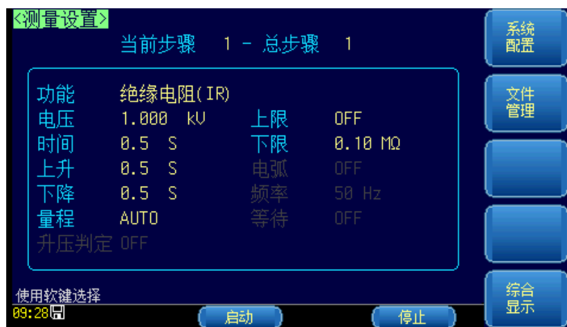
图 4-4 绝缘电阻测试参数设置页
