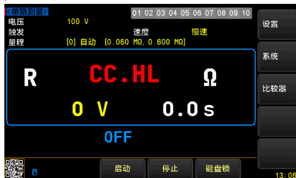
图 6-2 测试线全部接触不良
