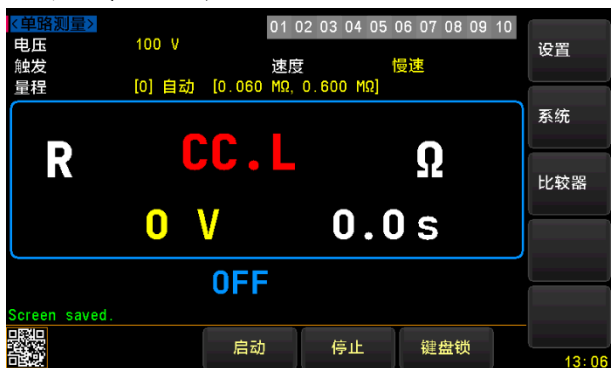
图 6-4 LOW (-) 端测试线接触不良
