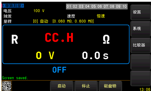
图 6-3 HIGH (+) 端测试线接触不良
