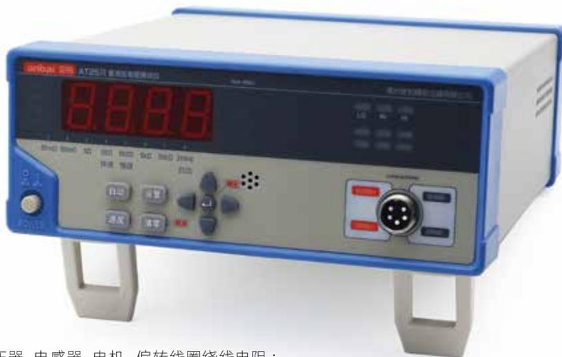
压器、电感器、电机、偏转线圈绕线电阻; 导线电阻车、船、飞机的金属铆接电阻; 印制版线条和孔化电阻等。
